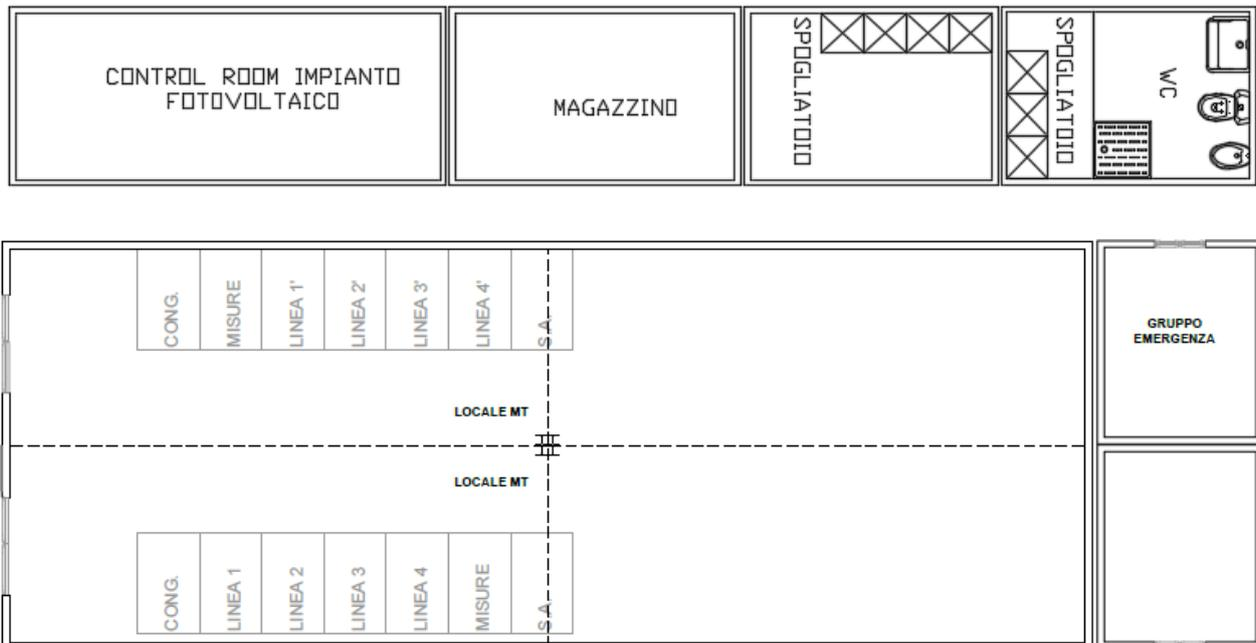
Le cabine, realizzate in box prefabbricati in Cemento Armato Alleggerito e box metallici, costituiscono i seguenti locali:
