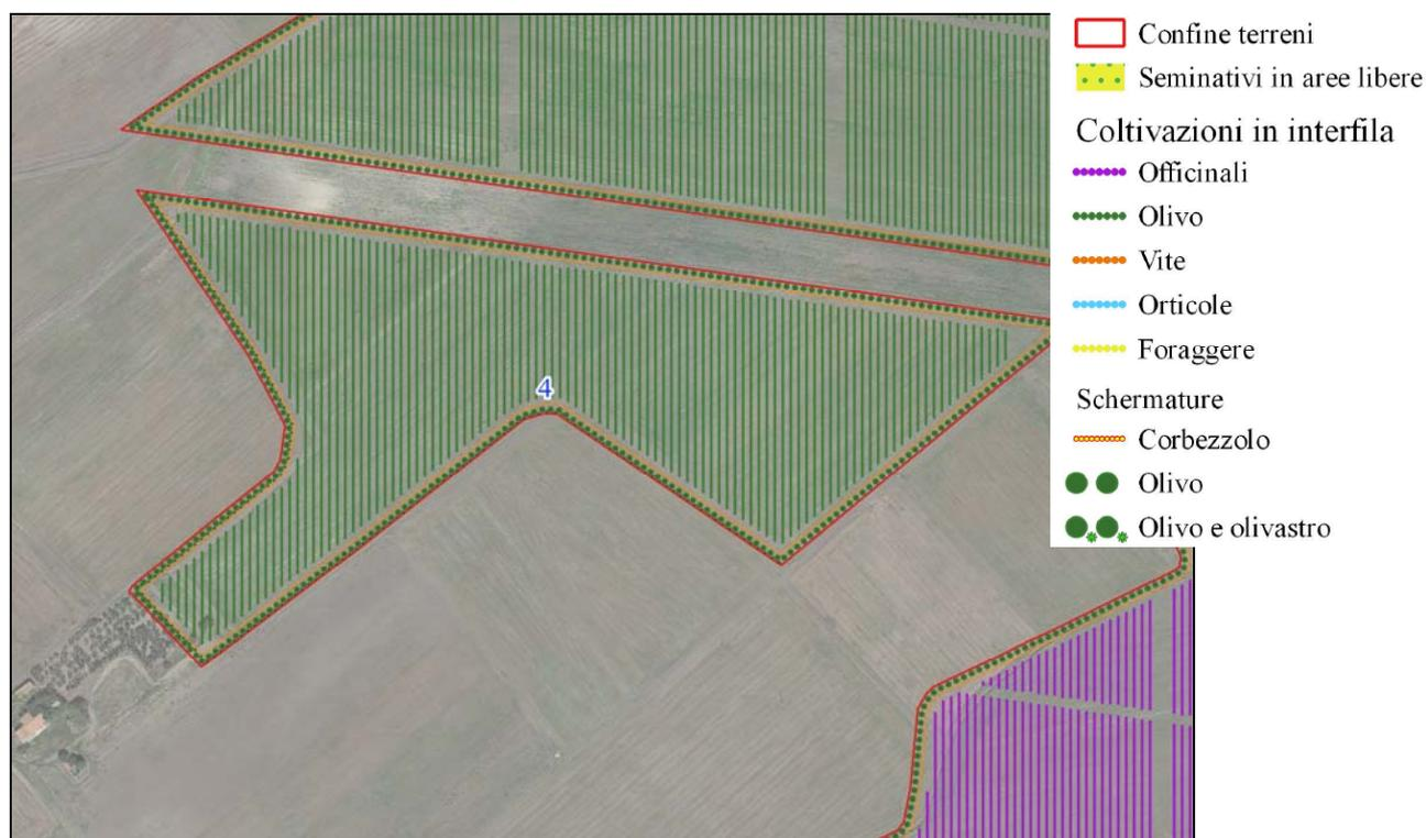
Figura 7e – dettaglio dell’appezzamento 5 con indicata la posizione delle fasce di mascheramento. In rosso il percorso della recinzione, fasce di mitigazione tipologia A, tipologia B e uso del suolo agricolo in campitura. Stralcio fuori scala per migliorare la visualizzazione del sito
