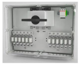
La scatola di stringhe serve anche come protezione contro le sovracorrenti inverse attraverso i fusibili installati sia sul polo positivo che sul polo negativo. Al suo interno sono poi installati gli scaricatori di sovratensioni e un sezionatore del carico all'uscita. Le scatole devono essere dotate di un sistema di monitoraggio della corrente di stringa, che deve rilevare i guasti con i relativi segnali di allarme. Le caratteristiche principali sono:
