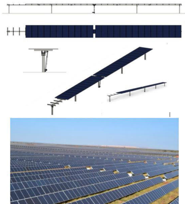
Figura 5-4 Modello 3D e fotografie esemplificative dei trackers utilizzati nel progetto
