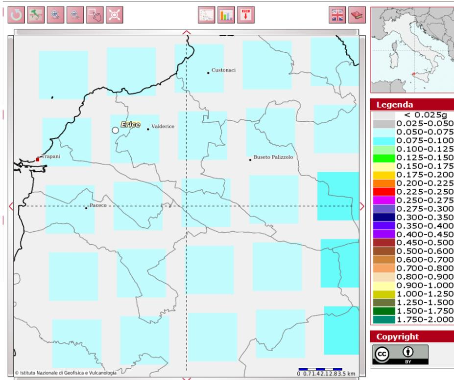
Mapa di pericolosità sismica redatta a cura dell'INGV di Milano secondo le Nuove Norme Tecniche per le Costruzioni - Punti della griglia riferiti a: parametro dello scuotimento  $a_g$ ; probabilità in 50 anni 10%; percentile 50.
