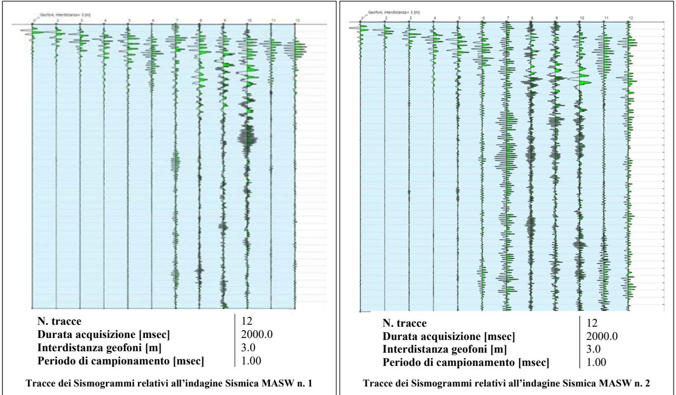
L'elaborazione del sismogramma ha consentito di estrapolare lo spettro di velocità (fig. a) dal quale si è risalito tramite picking alla curva di dispersione che consente di ottenere sia gli spessori dei vari strati che le rispettive velocità.
