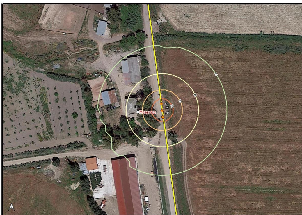
Figura 8 – Stralcio planimetrico della isofone calcolate in corrispondenza del recettore residenziale RC01 nelle fasi di cantiere maggiormente critiche (Fase 19).
