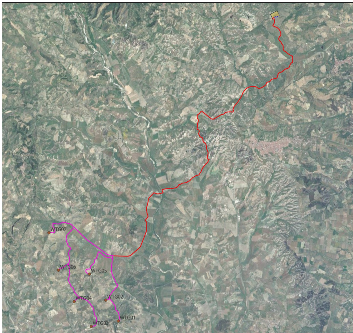
Figura 3 - Ubicazione dell'impianto eolico e delle opere di connessione su ortofoto.
