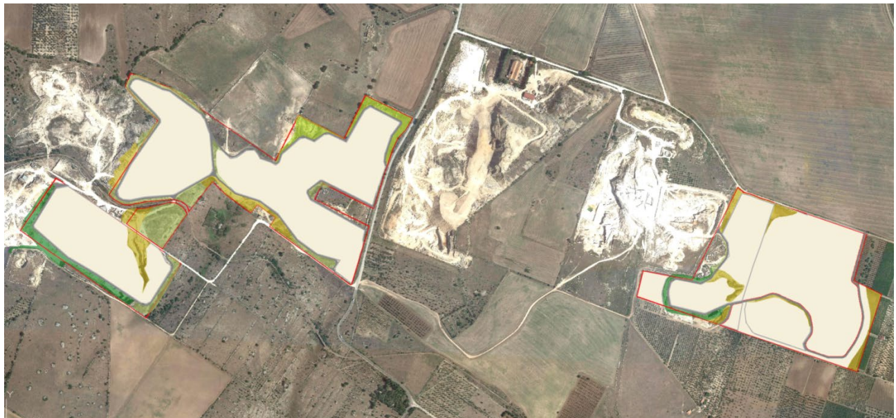
Figura 4: schema delle superfici occupate. In avana le superfici di impianto, nei toni del verde le aree rinaturalizzate.
