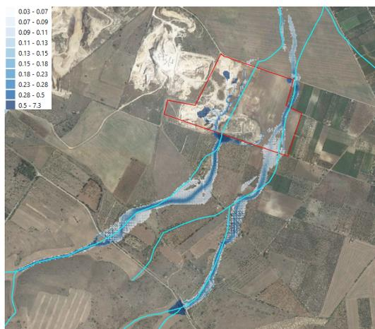
*Portata di piena a 200 anni dello stato di fatto del compluvio A (in alto a sinistra), del compluvio B (in alto a destra) e dei compluvi C e D (in basso al centro)*
