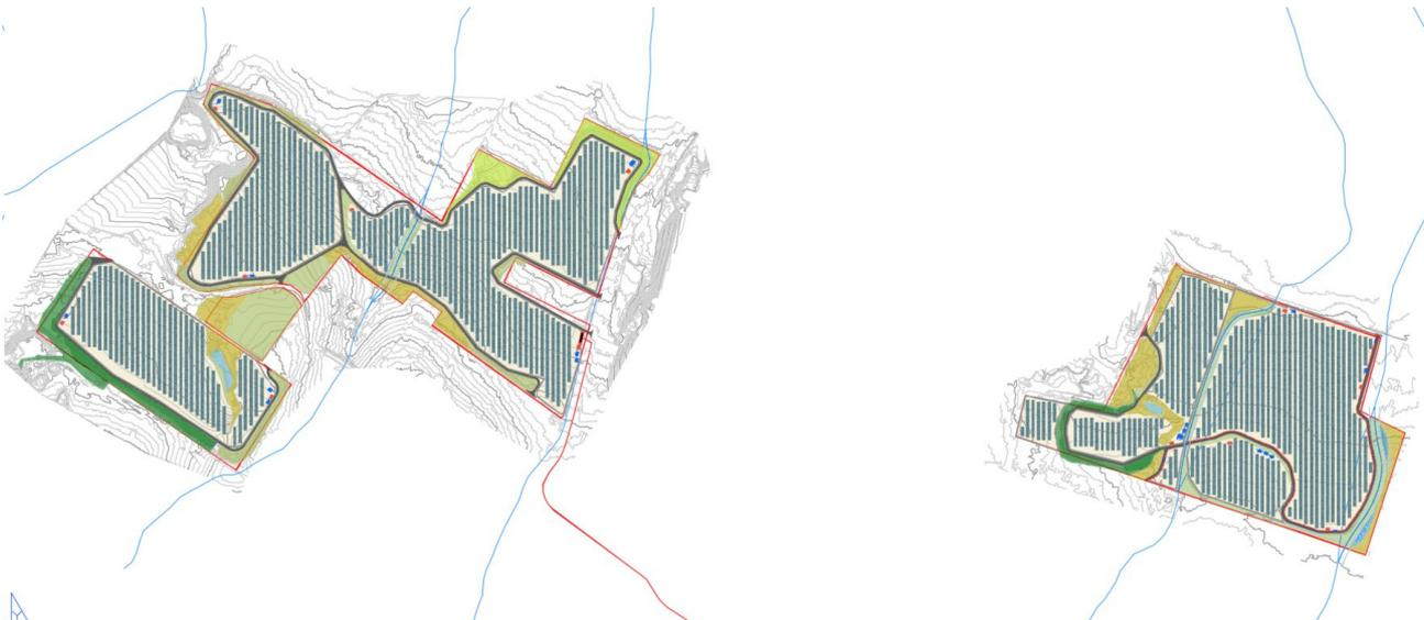
*Planimetria di progetto con gli interventi di ricostruzione del reticolo idrografico*
