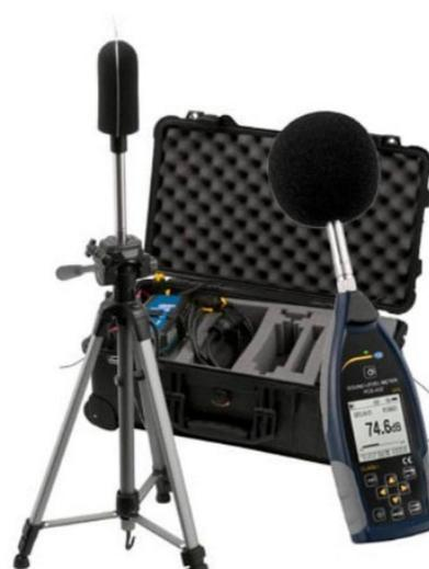
La strumentazione di misura è conforme alla classe 1 delle norme EN 60651/1994 e EN 60804/1994. La catena di misura da adottarsi è generalmente costituita da un fonometro, un preamplificatore ed un microfono.
