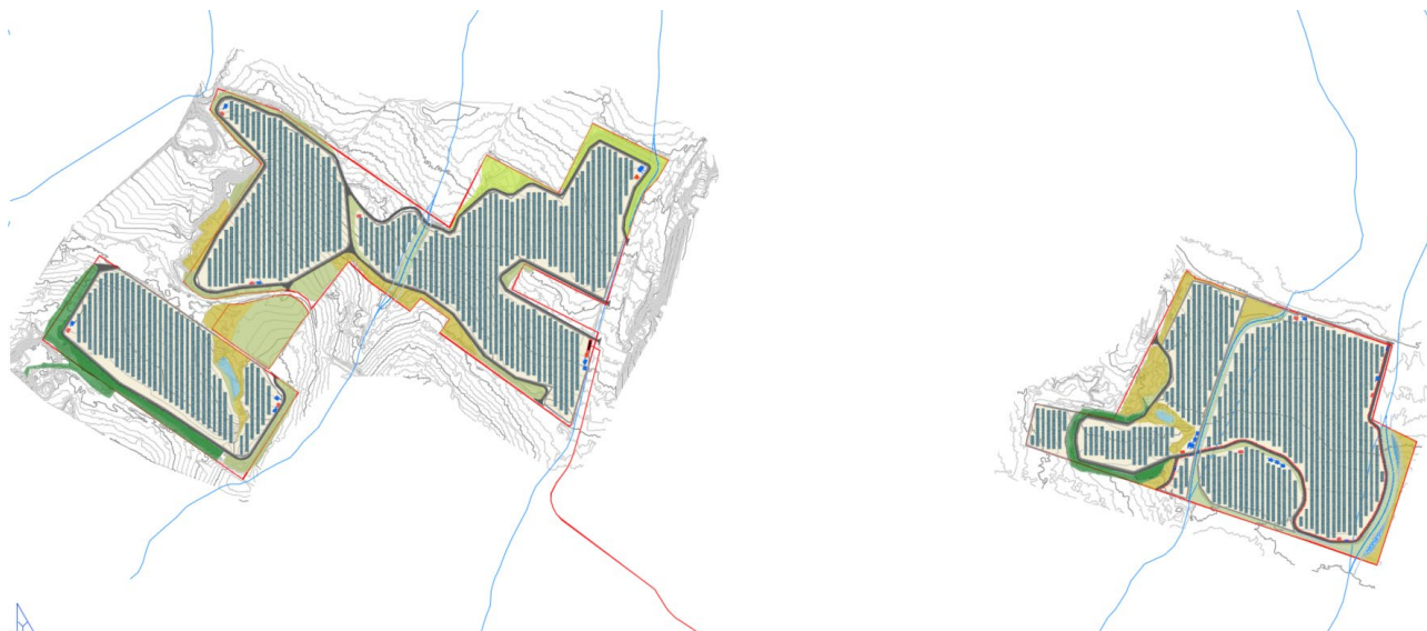
Planimetria di progetto con gli interventi di ricostruzione del reticolo idrografico
