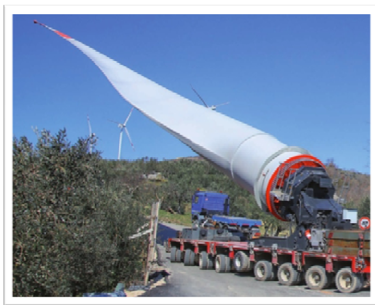
Figura 6 - Rimorchio speciale provvisto di sollevatore. Consente di ridurre il raggio di curvatura laddove sono presenti curve e/o tornanti particolarmente stretti. Il rimorchio si può accorciare con un sistema telescopico e il carico può essere inclinato per ridurre l'ingombro longitudinale complessivo.
