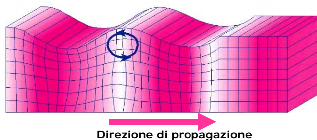
Fig. 36 - Rappresentazione grafica della propagazione delle onde superficiali di Rayleigh caratterizzata dall'oscillazione polarizzata in un piano verticale e con movimento delle particelle retrogrado rispetto alla direzione di propagazione dell'onda.
