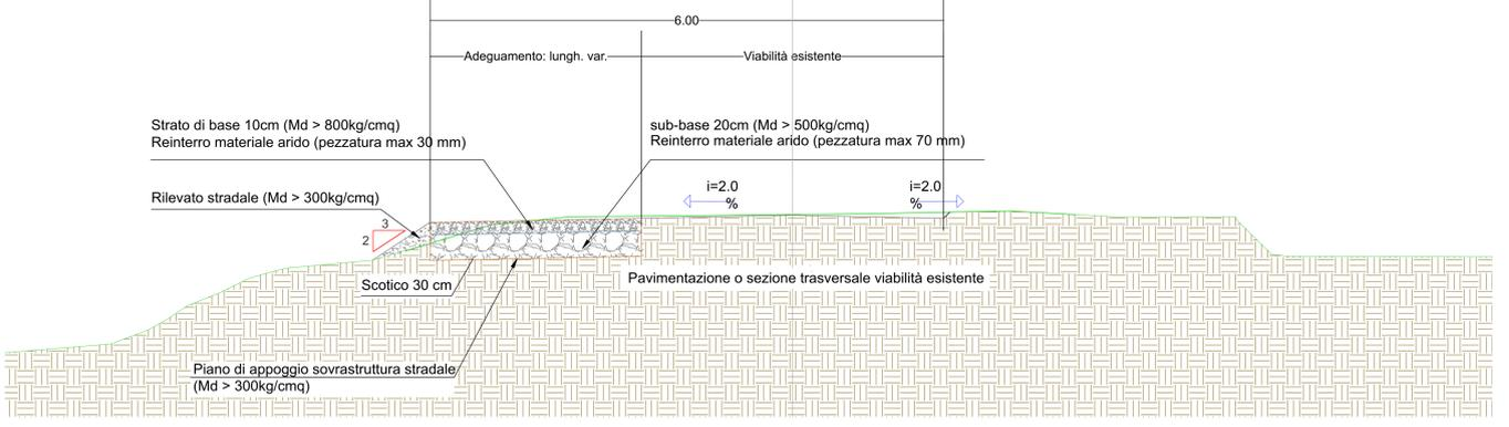
**SEZIONE TIPICA VIABILITÀ ESISTENTE CON ADEGUAMENTO SUL LATO DESTRO**
