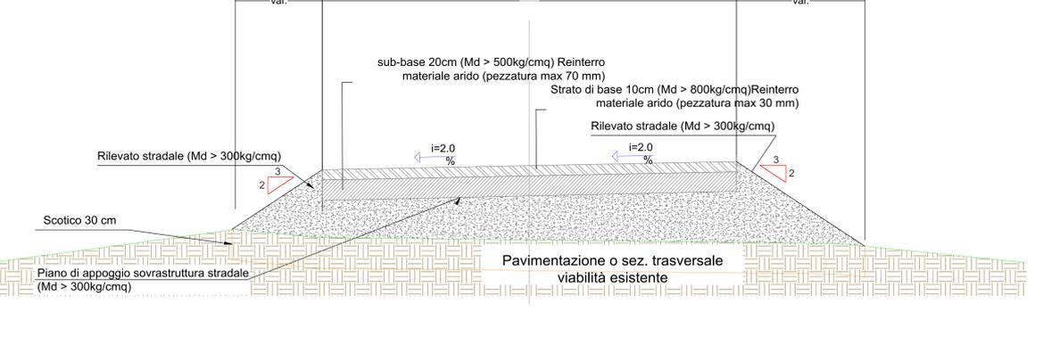
**SEZIONE TIPICA VIABILITÀ DA REALIZZARE IN SCAVO**
