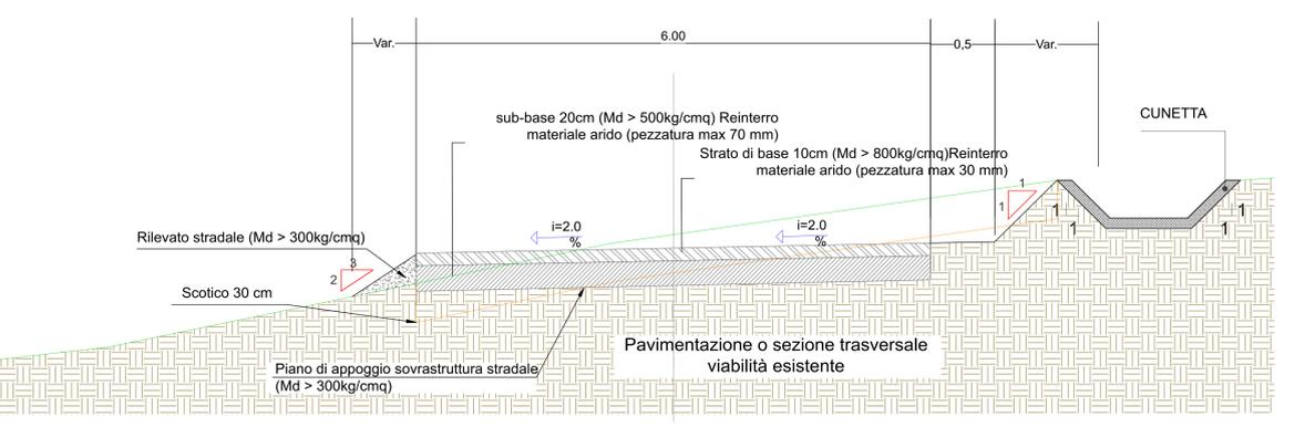
**SEZIONE TIPICA VIABILITÀ DA REALIZZARE IN RILEVATO**
