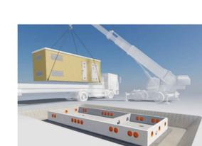
Simulazione installazione cabina elettrica di tipo prefabbricato.
