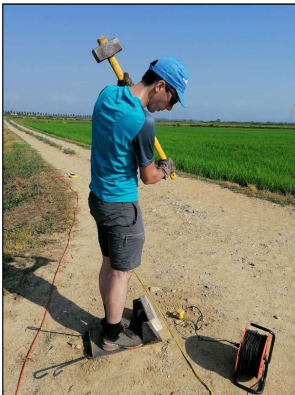
Figura 12 Energizzazione per onde di Rayleigh
