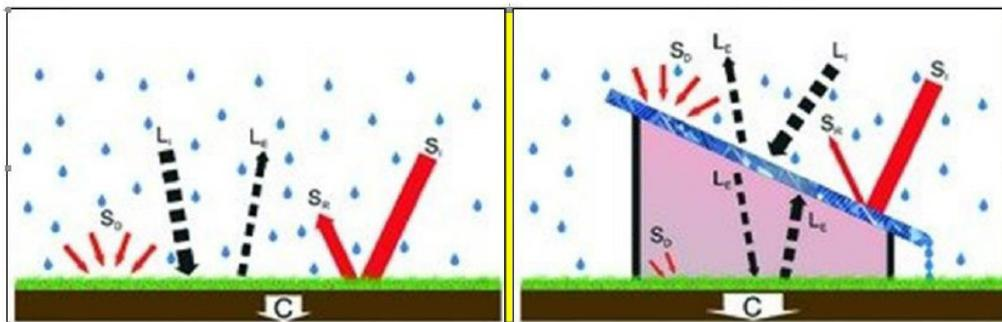
Confronto tra uno schema delle forzanti atmosferiche e delle loro interazioni al suolo in una condizione priva di pannelli solari (a sinistra) e in presenza di pannelli (a destra) (Armstrong et al., 2014)
