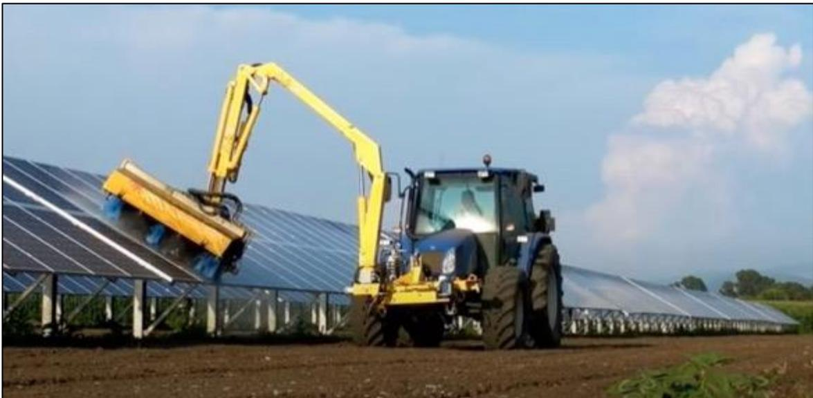
Figura 19. Trattore con macchina per il lavaggio dei pannelli.
