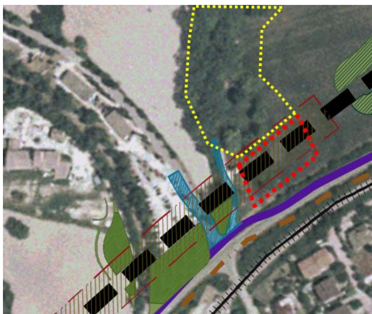
Figura 3 Aree interferenti con esemplari di Roverella (in rosso tratteggiato alberi direttamente interessati dalla realizzazione dell'opera, in giallo tratteggiato alberi non interessati.)
