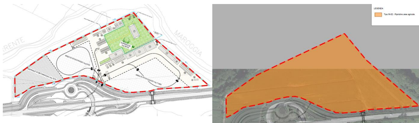
Figura 6: Area di cantiere n. 2 – “Baiano” a destra riambientazione
