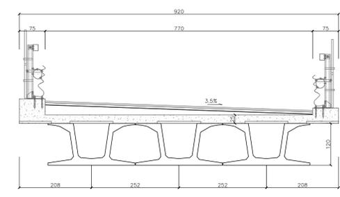
SEZIONE IN CORRISPONDENZA DELLE ASOLE PER ISPEZIONE
