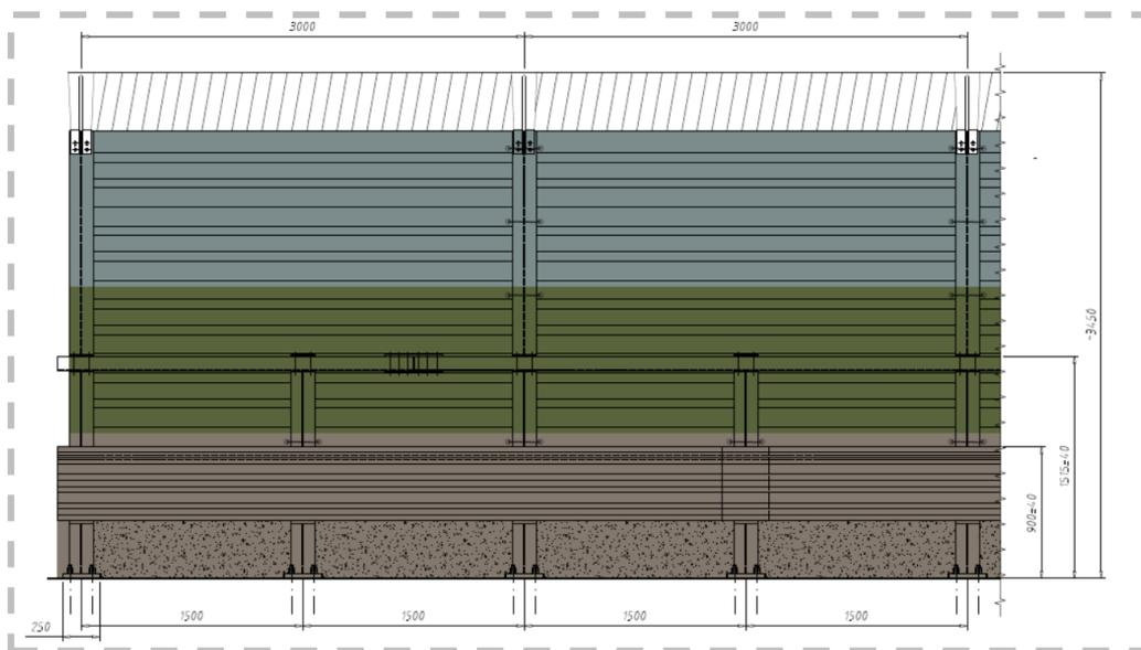
Figura 4.2 - Particolare barriera antirumore in viadotto BAO2: paesaggio antropizzato
