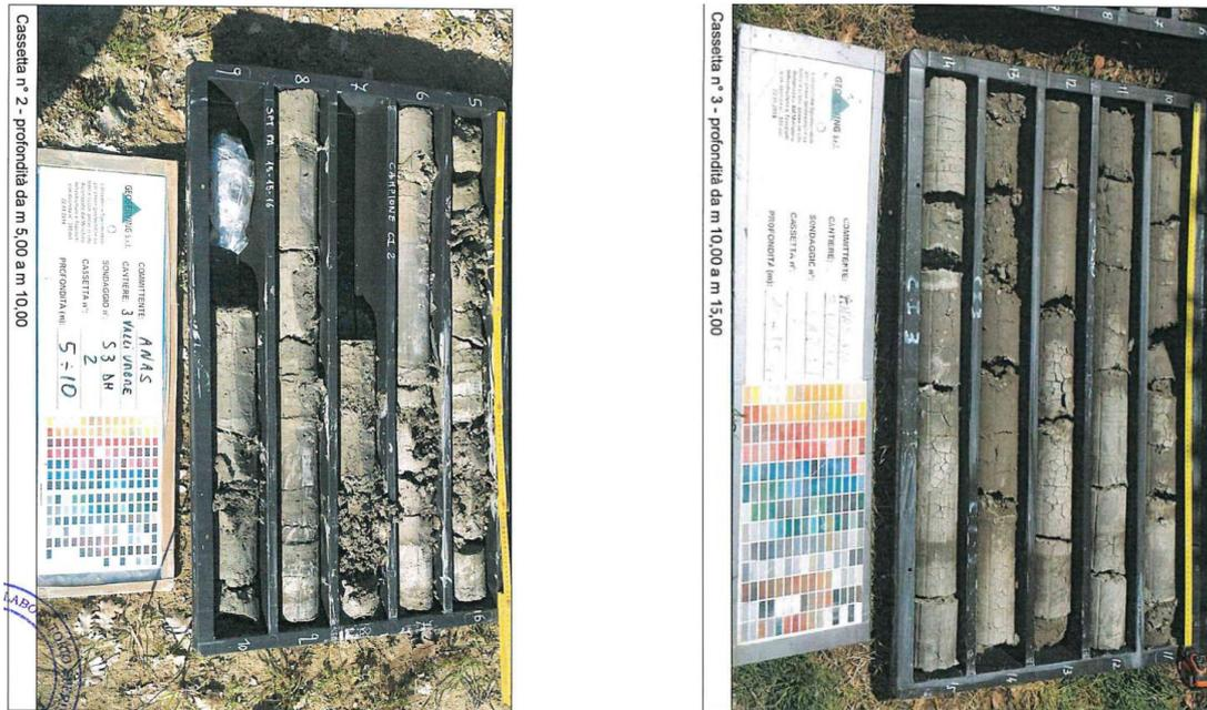
Figura 6:11: Unità geotecnica SCH – S3/21 (sinistra) e SA2/21 (destra).
