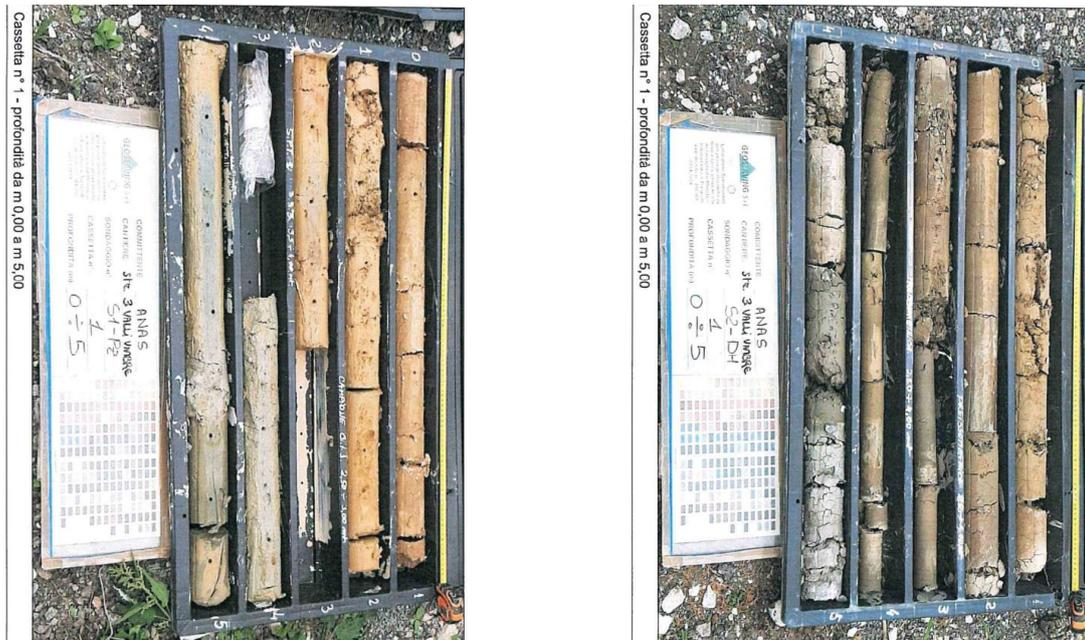
Figura 6:17: Unità geotecnica SCC1 – S1/21 (sinistra) e S2/21 (destra).
