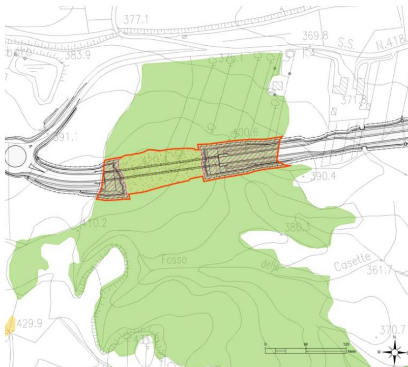
**Figura 4-1. Taglio alberi in corrispondenza della Galleria Artificiale Romanella (14.200 mq). Previsto parziale rimboschimento (6.400 mq)**
