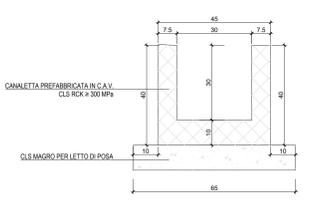
**DETTAGLIO COLLEGAMENTO TRA CANALETTA E FOSCO DI GUARDIA PIANTA**
