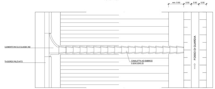
**DETTAGLIO GRADONATURA (PER P.C. >15%)**
