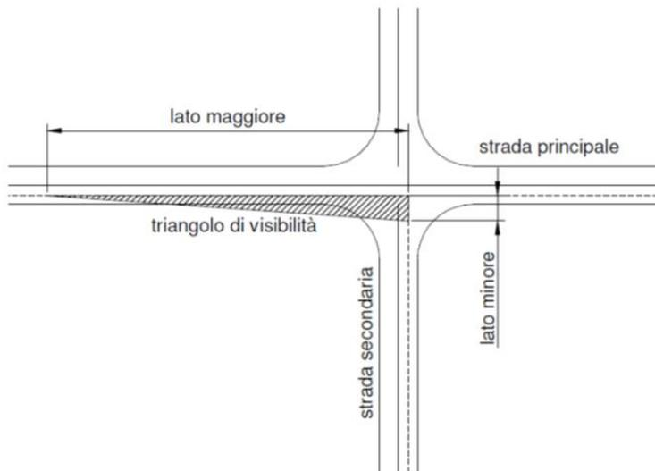
Nel progetto in studio l'immissione è regolata da STOP, il lato minore del triangolo misura 3 m dalla linea di arresto.
