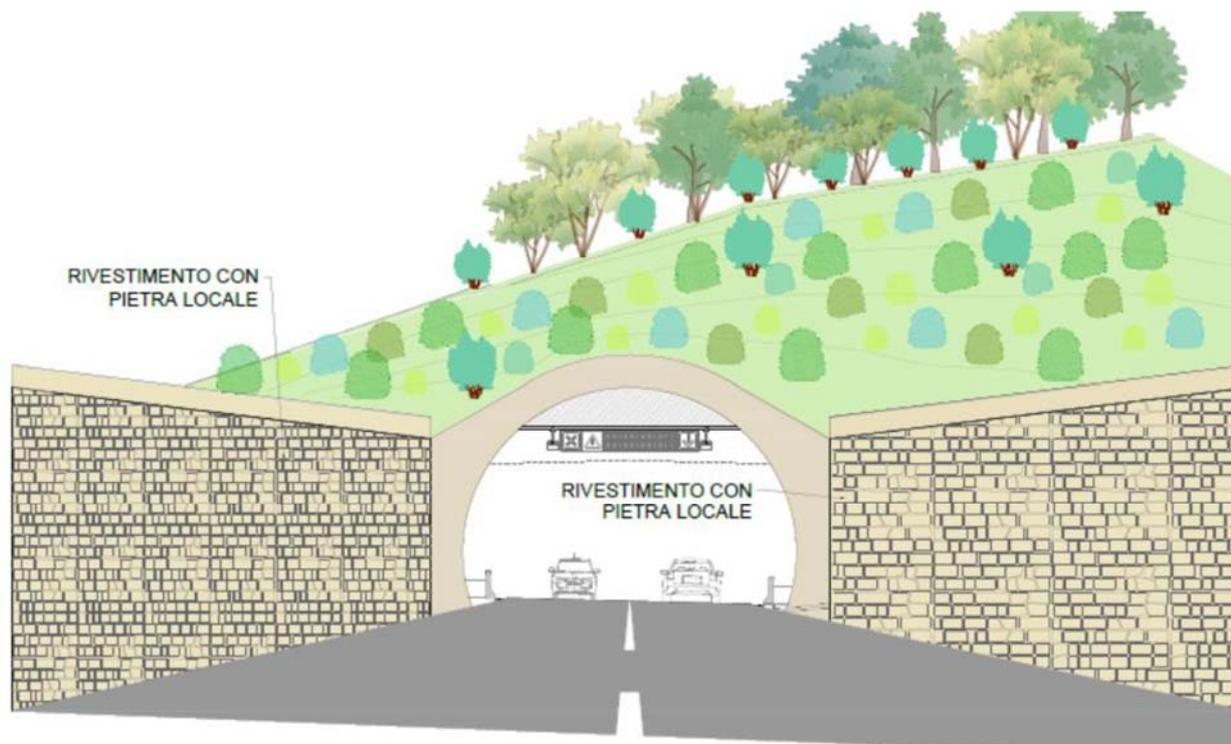
Figura 5: Sezione di imbocco Galleria artificiale Romanella.
