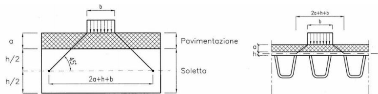
Figura 5.1.3a – Diffusione dei carichi concentrati nelle solette
