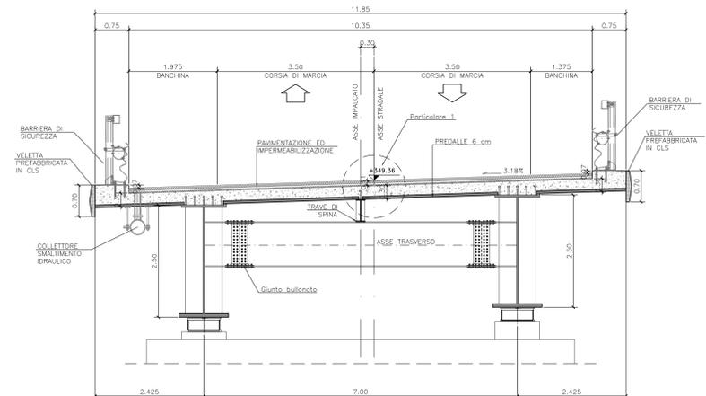
**SEZIONE TRASVERSALE PILA 7**
