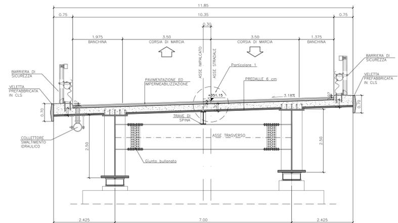
**SEZIONE TRASVERSALE PILA 5**
