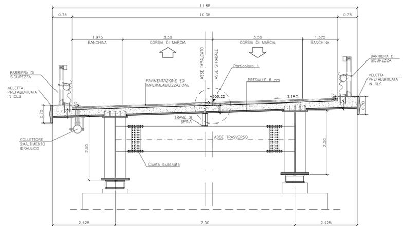
**SEZIONE TRASVERSALE PILA 6**
