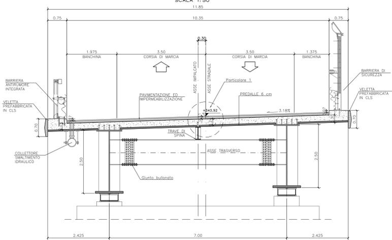
SEZIONE TRASVERSALE PILA 14
