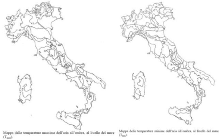
Figura 5-2 Isotherme (cfr. N.A.D. En 1991-1-5)
