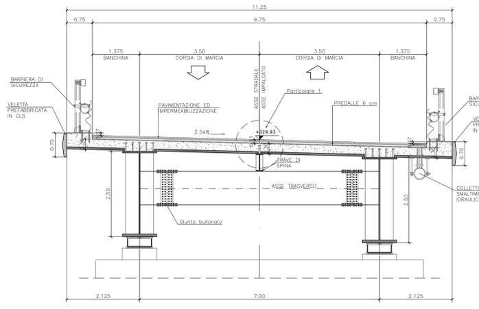
**SEZIONE TRASVERSALE PILA 11**
