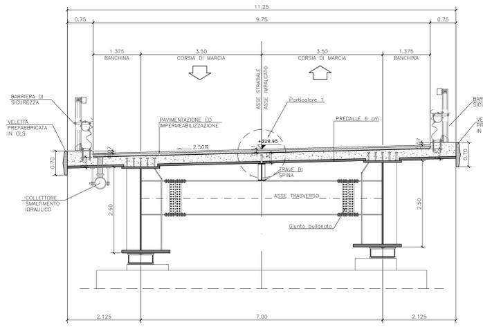
**SEZIONE TRASVERSALE PILA 9**
