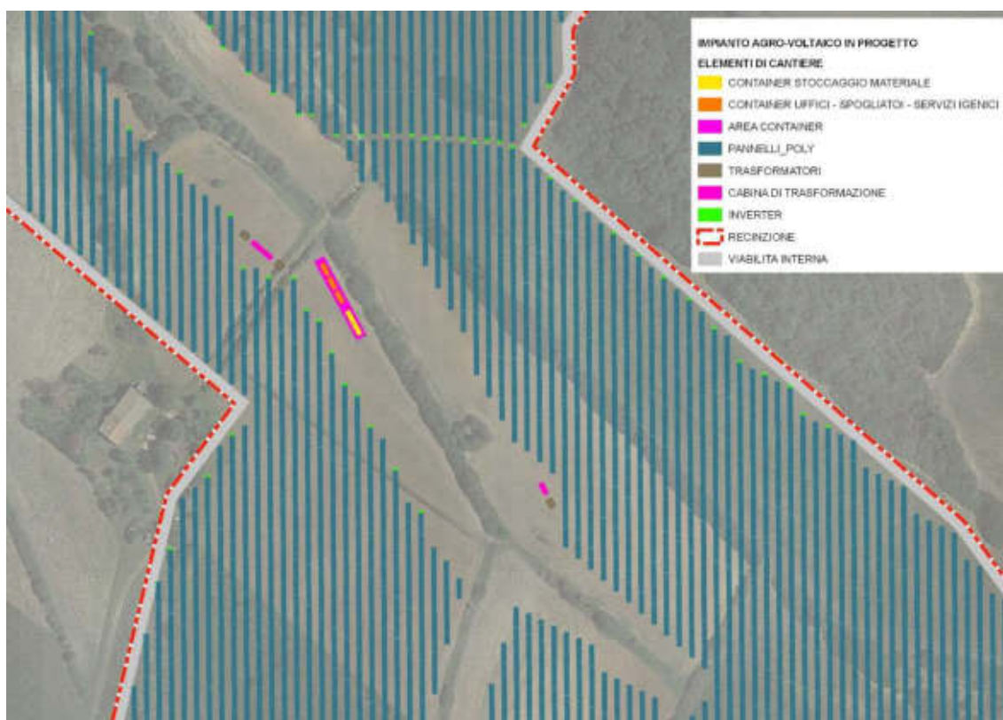
Figura 70 - Area di cantiere - dettaglio 1 – Lotto 1
