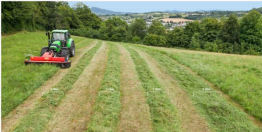
Figura 30 – Immagine della falciatrice anteriore e larghezze delle andane realizzabili
