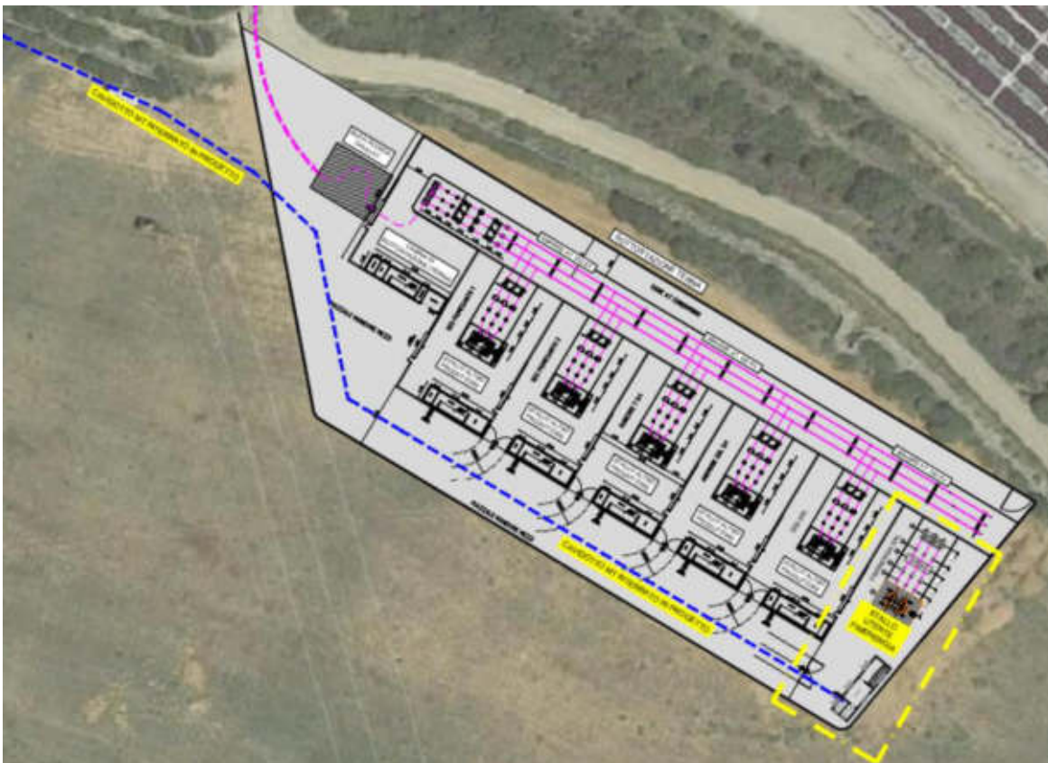
Figura 20 - Planimetria della sottostazione Terna e stallo utente FimEnergia (da elaborati di progetto)
