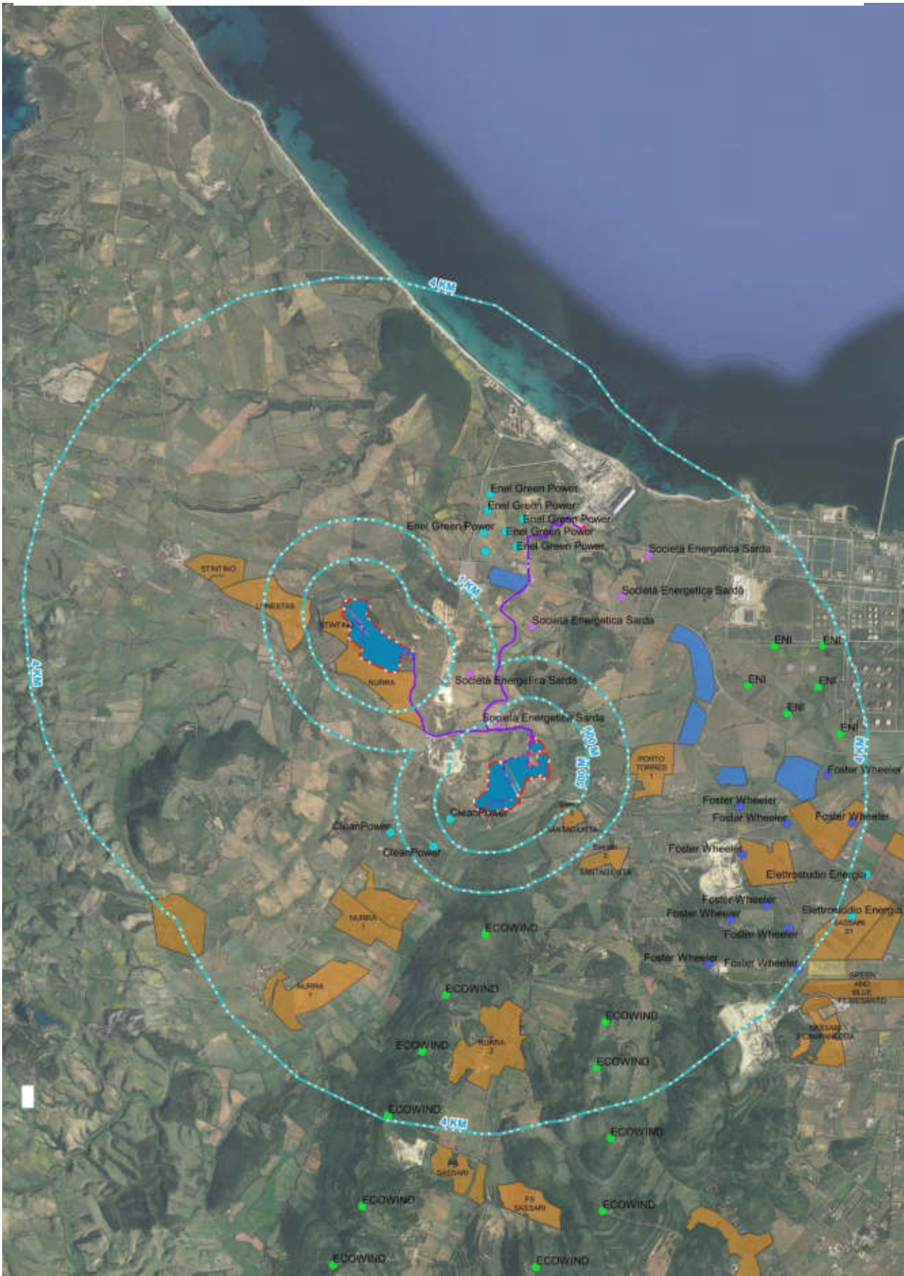
Figura 15 - Impianti FER presenti e proposti nelle fasce buffer identificate, rispetto al progetto in esame
