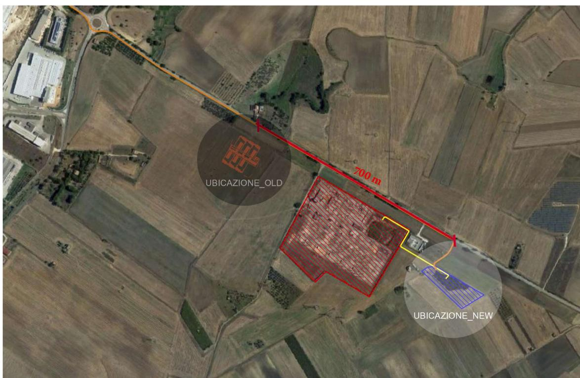
Il preventivo di connessione Terna ottenuto dalla società Green Italy Jesce Srl, si collega all'Esistente Stazione Elettrica "Matera". L'ubicazione scelta segue necessariamente il progetto ben più ampio della pre-esistente SE (già di proprietà Terna Spa), che prevede, al suo interno, l'ampliamento della SE 380 / 150 kV TERNA denominata "Matera" su uno stallo a 150 kV.
