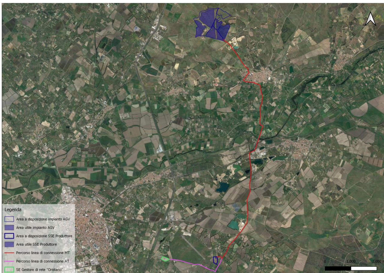
Figura 3: Stralcio aerofotogrammetria con indicazione del campo AGV e della linea di connessione (fonte Google Earth).
