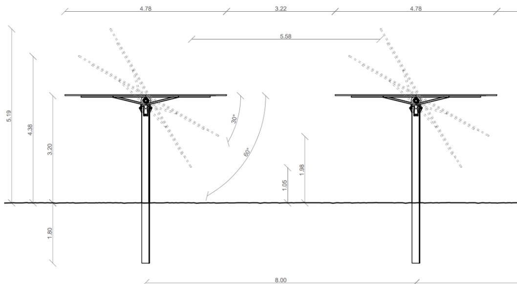
Figura 1: Prospetto trasversale Tracker Tipologia 2V (vista Est-Ovest).
