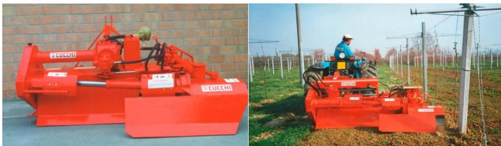
Figura 8: Esempio di fresatrice interceppo per le lavorazioni sulla fila (fonte Cucchi Macchine Agricole).
