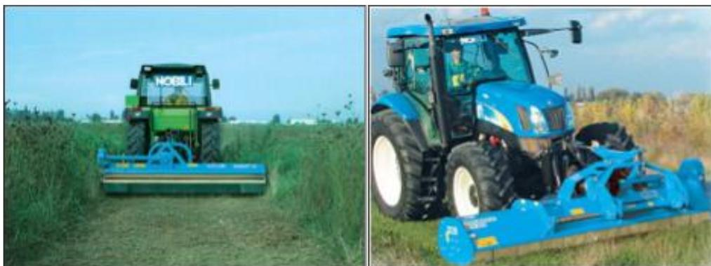
Figura 14: Esempi di trincia posteriore e anteriore di notevole larghezza.
