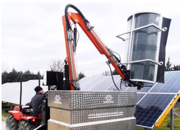
Figura 9: Esempio di macchina pulitrice applicabile a trattori agricole
