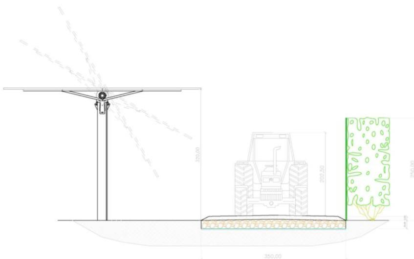
Figura 5: Sezione tipo strada perimetrale impianto.
