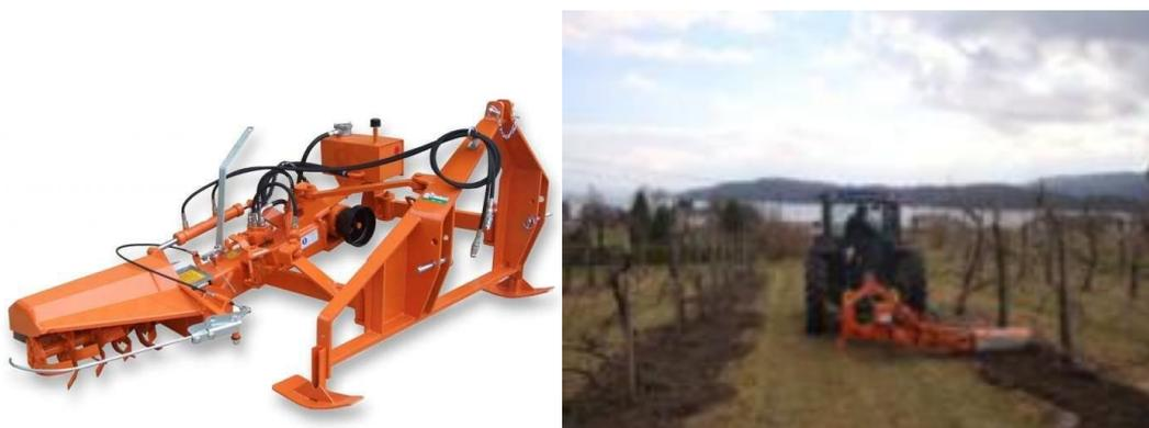
Figura 11: Esempio di fresatrice interceppo per le lavorazioni sulla fila.
