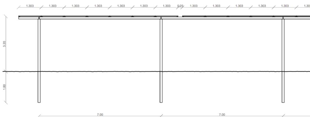
Figura 2: Prospetto longitudinale Tracker (vista Nord-Sud).
