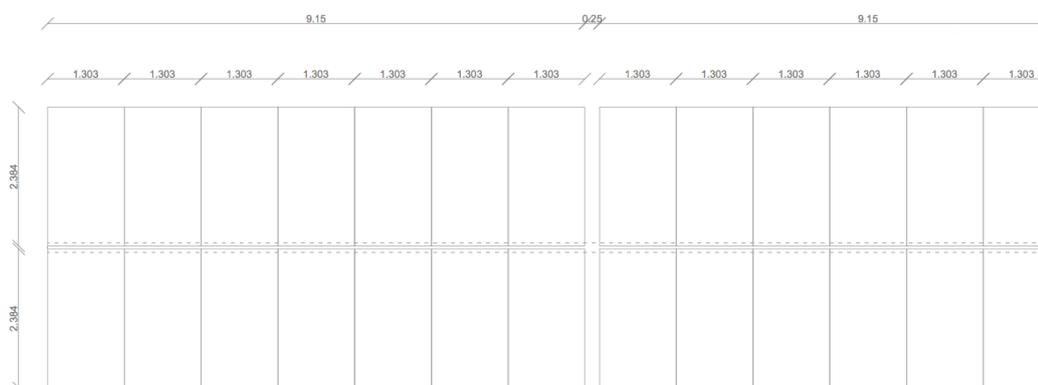
Figura 3: Dettaglio Tracker Tipologia 2V (moduli 28x2) PIANTA.
