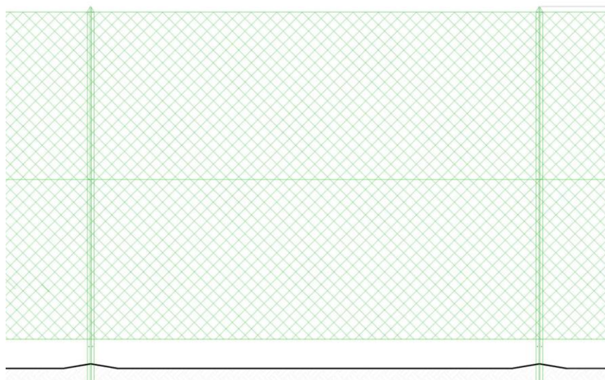
Figura 59: Particolare recinzione perimetrale con apertura inferiore (20-30 cm).
