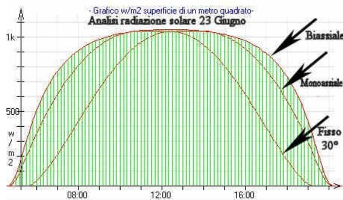
Figura 173 - confronto tra sistemi di produzione fisso-inseguimento monoassiale – inseguimento biassiale
