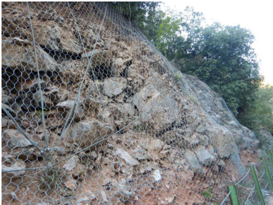
Figura 17 – Depositi detritici della conoide del Rio Montefiorello; costituiti da blocchi e ciottoli con ghiaia in matrice sabbiosa
