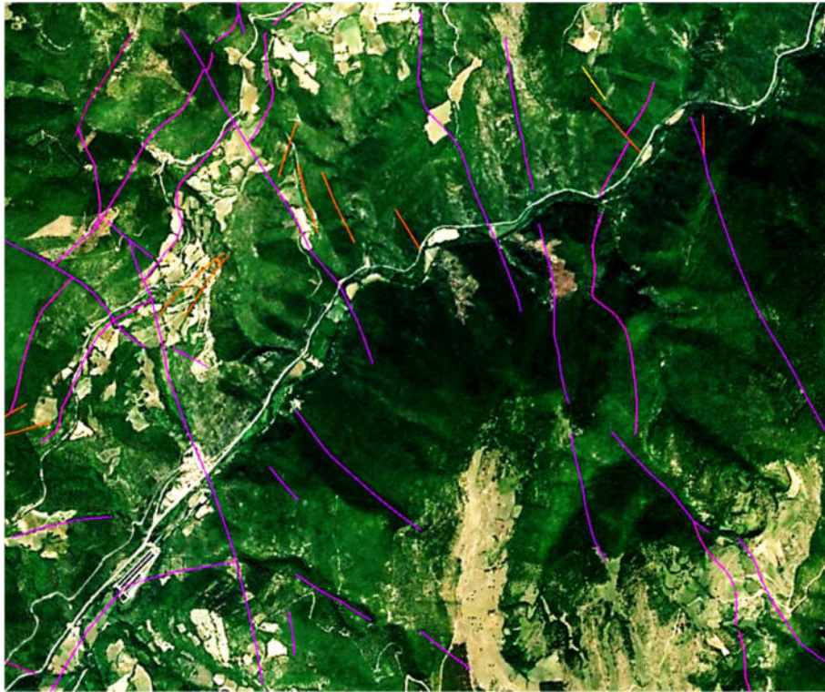
Figura 4 – Principali elementi tettonici riconosciuti nell'area di studio (Banca dati del Servizio Geologico e Sismico Regionale - Regione Umbria); In viola: faglia normale, in rosa: faglia inversa/sovrascorrimento; in arancione: faglie presunte
