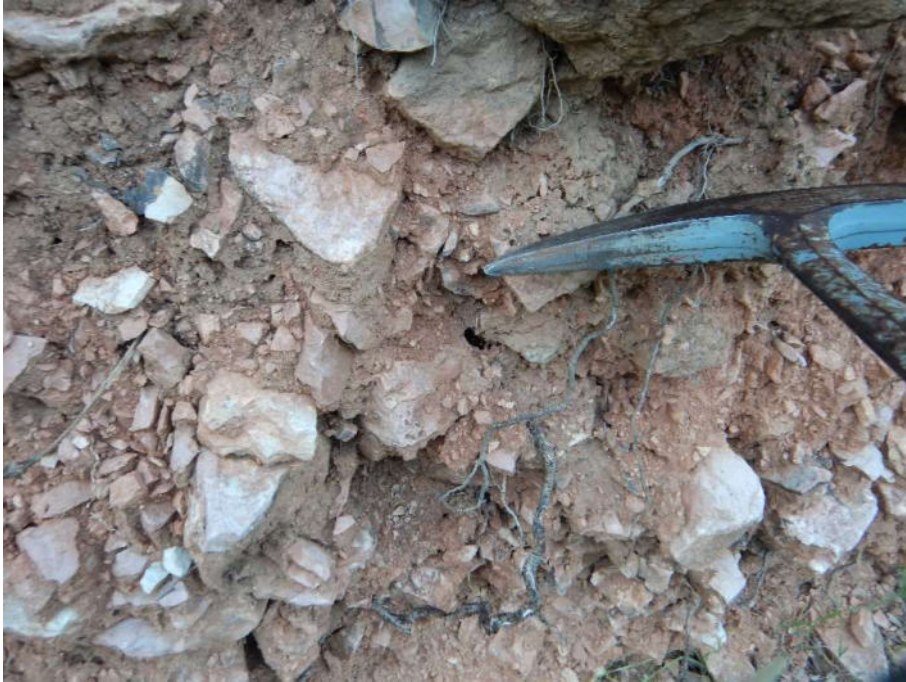
Figura 11 – Detriti di falda/conoide misto; depositi a granulometria variabile, eterometrici con clasti a spigoli vivi, rinvenuti l'ungo il tracciato a Pk 0+300 circa
