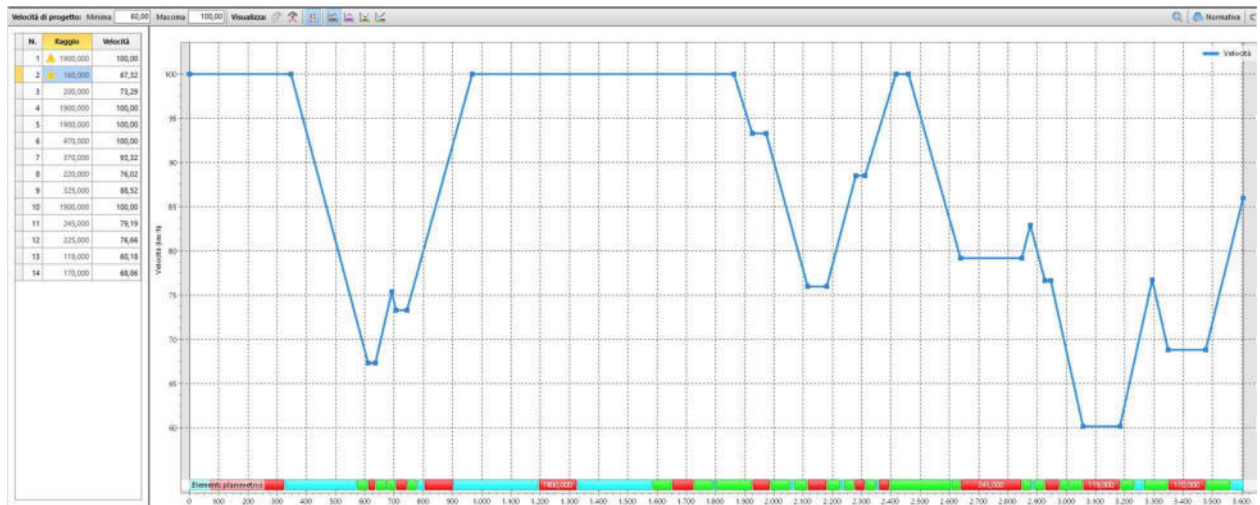
Figura 2 - Diagramma delle velocità dell'alternativa 3 (velocità senza limitazioni)
