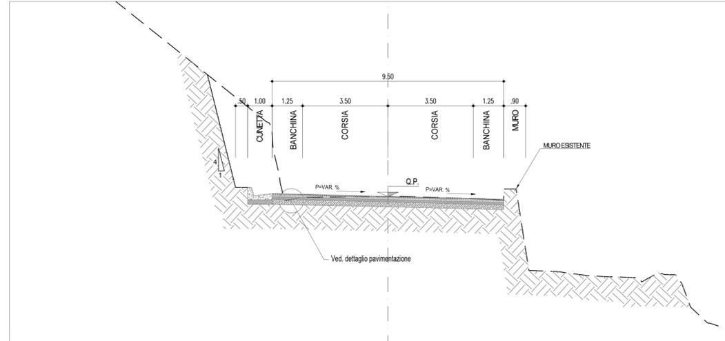
SEZIONE TIPO C-C CON CORSIA DI ACCUMULO
