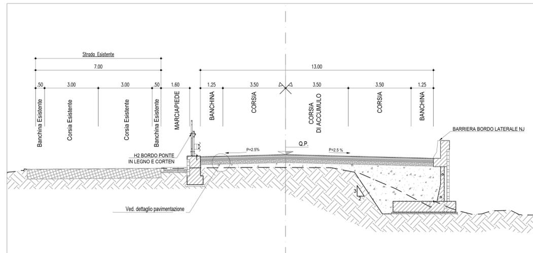
SEZIONE TIPO E-E CON MURO DI CONTRORIPA IN SINISTRA
