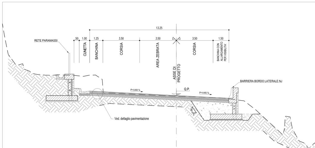
SEZIONE TIPO D-D CON COMPLANARE IN AFFIANCAMENTO E CORSIA DI ACCUMULO E MURO DI SOSTEGNO IN DESTRA
