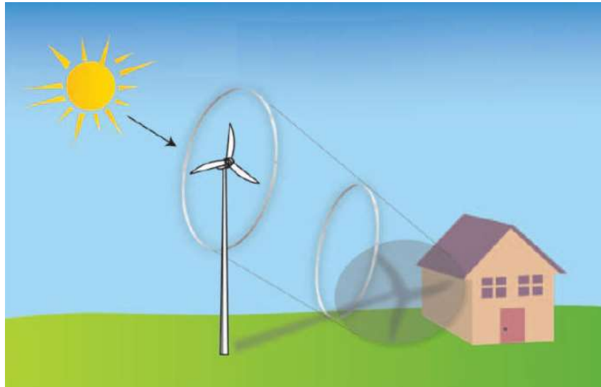
Figura 15. Illustrazione del fenomeno di shadow flickering
