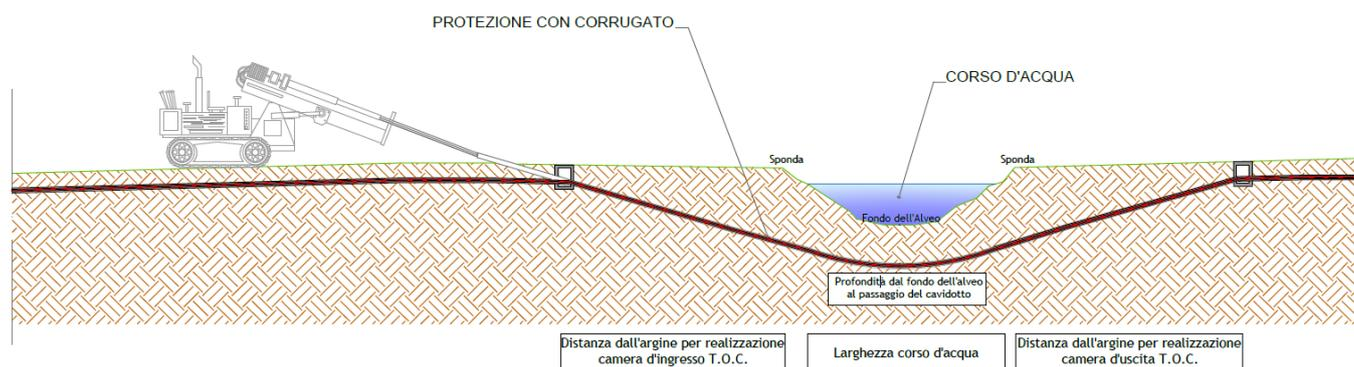
Figura 3: Sezione longitudinale attraversamento in T.O.C.
