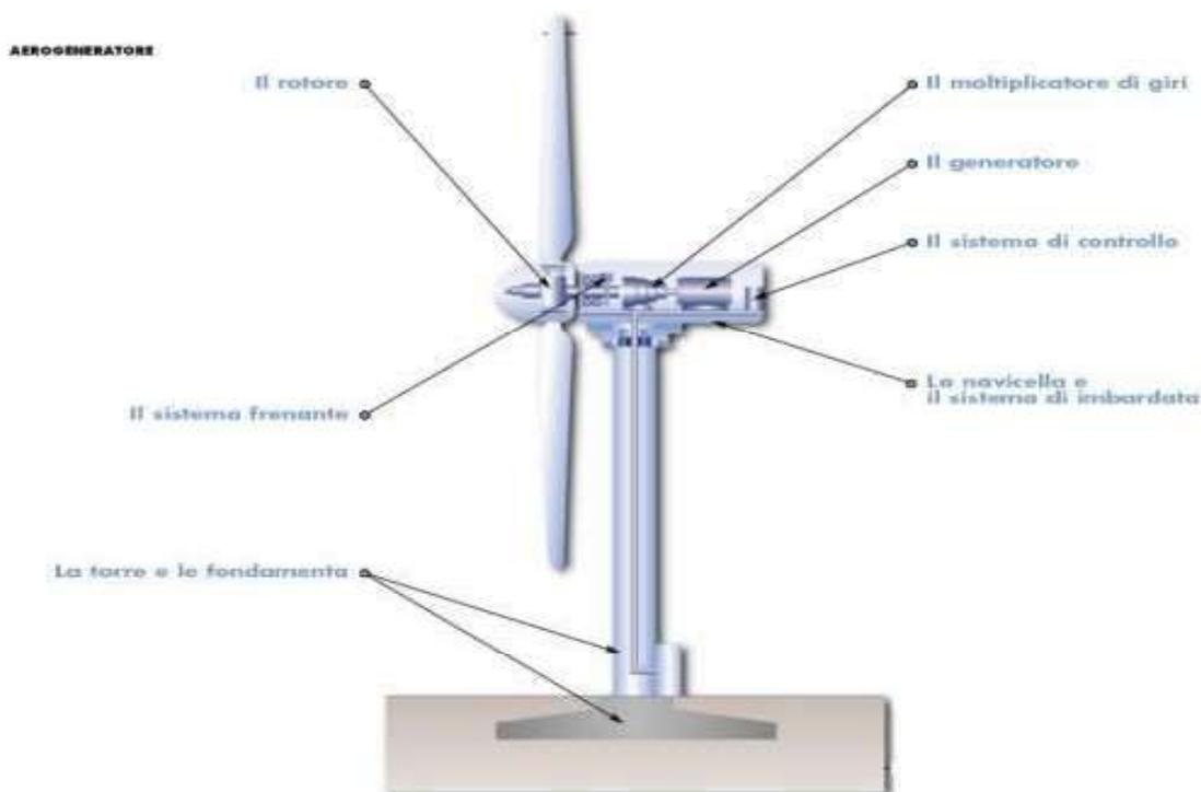
Figura 2 – Schematizzazione aerogeneratore
