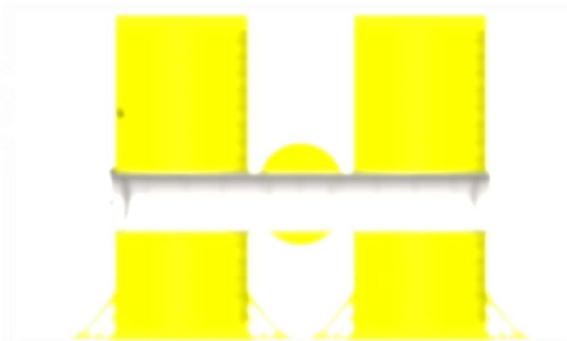
Figura 4.8 – Vista della sezione della connessione perno/malta con le casse di zavorra
