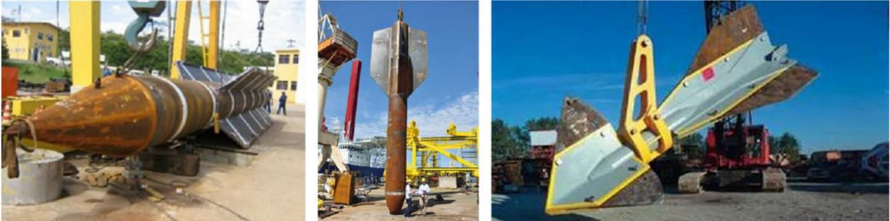
**Figura 6.3 – Ancoraggio a gravità ad infissione dinamica.**
