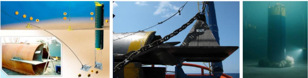
Figura 6.7 – Ancoraggio a suzione con piastra.
