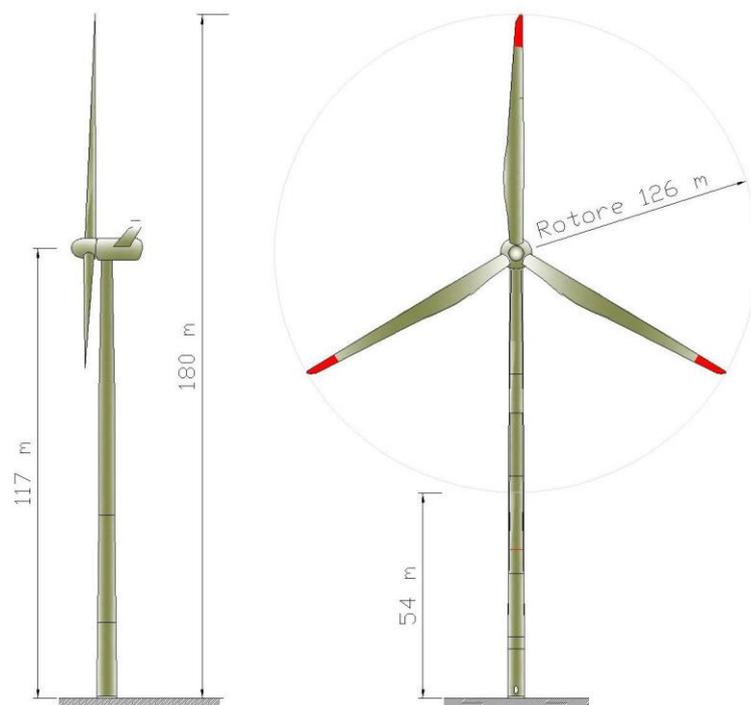
Figura 2. Caratteristiche dimensionali aerogeneratore
