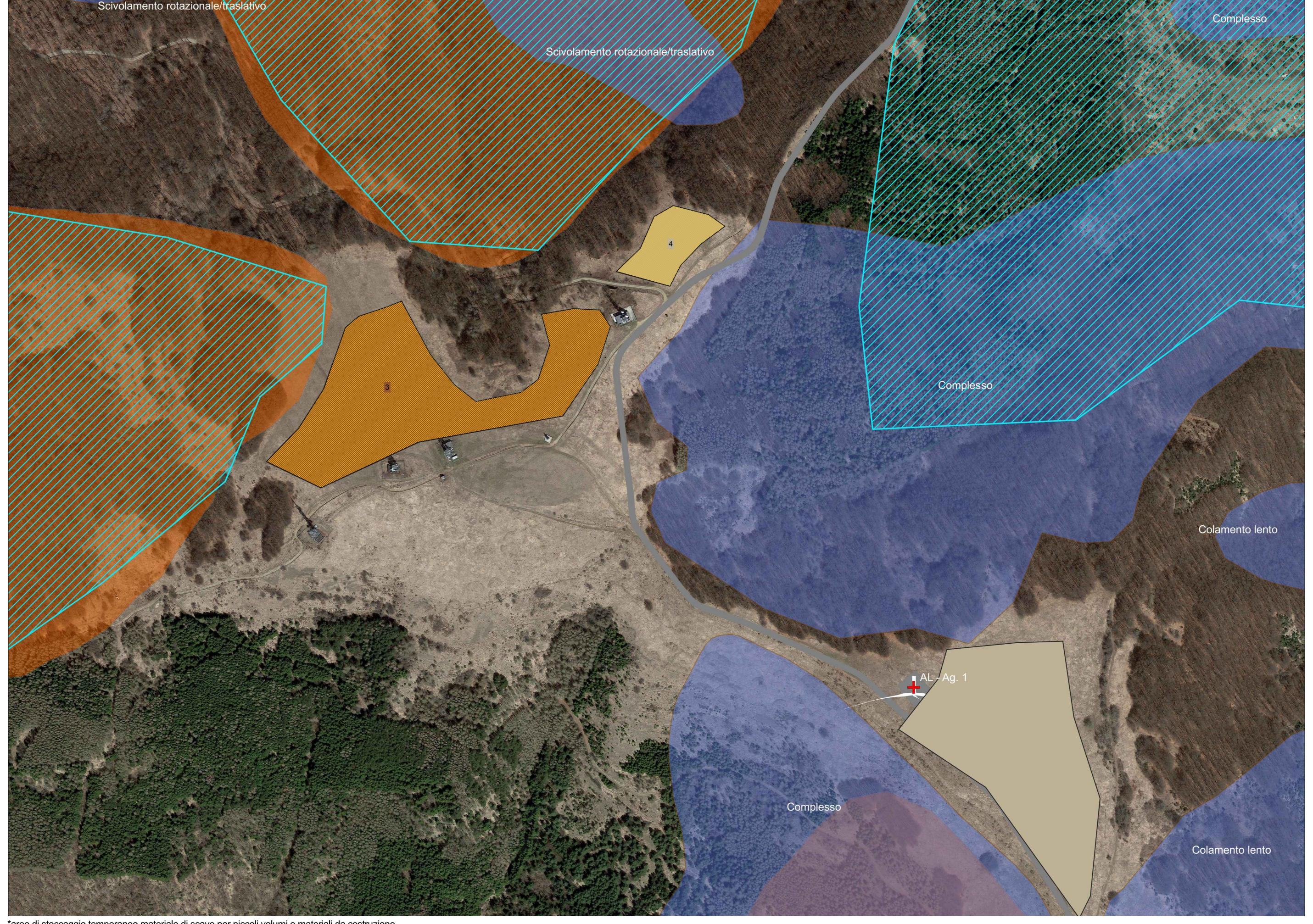
\*aree di stoccaggio temporaneo materiale di scavo per piccoli volumi o materiali da costruzione Area deposito 3: 35.850mq Area deposito 4: 5565mq
