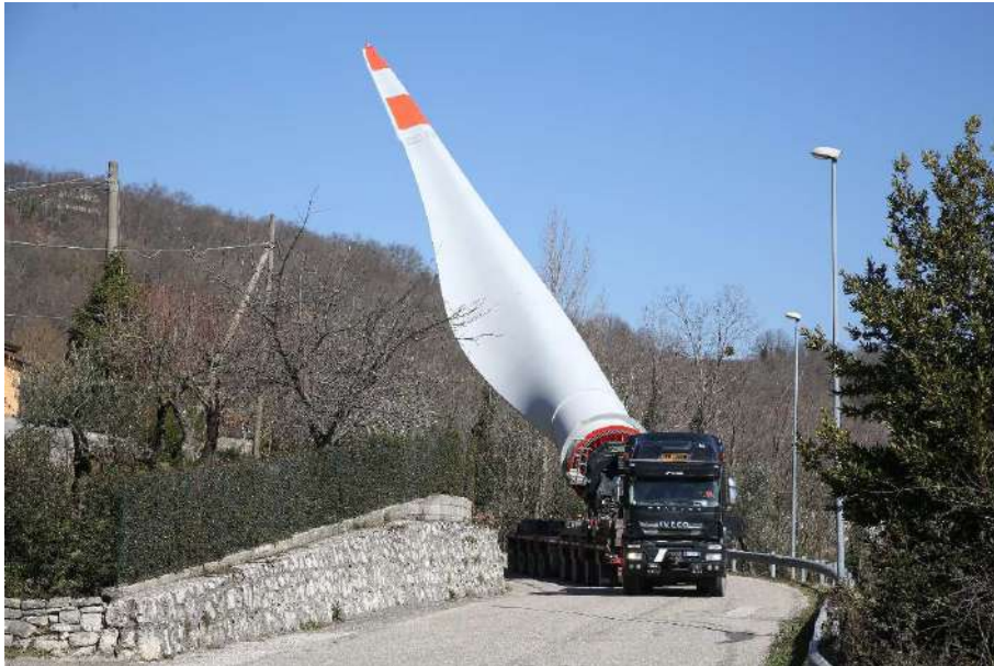
Figura 4 - Esempio di un mezzo semovente, trainato da trattore stradale, con pala inclinata.
